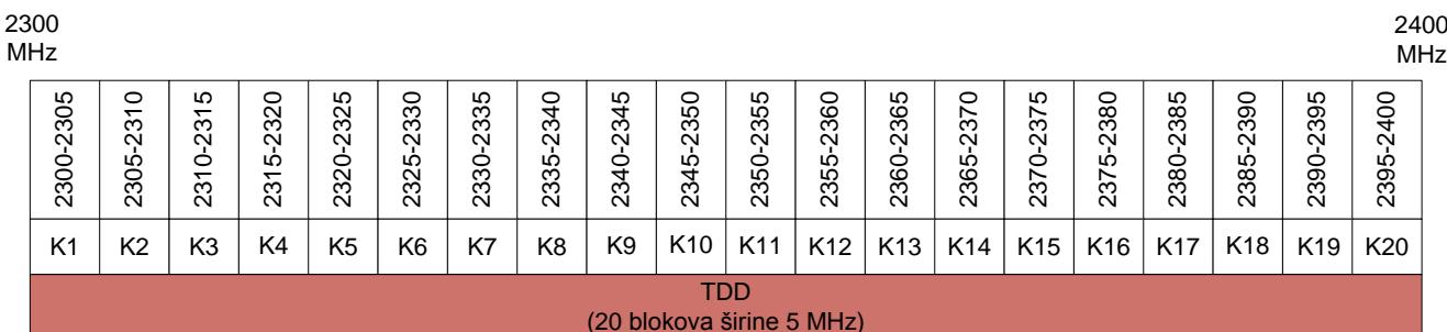
Slika 1 - Grafički prikaz raspodjele radio-frekvencijskih blokova za MFCN (TRA-ECS) sisteme
